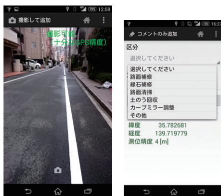
写真-2 スマホによる点検・補修記録
