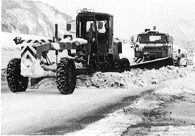
除雪グレーダーと除雪トラックによる圧雪処理
