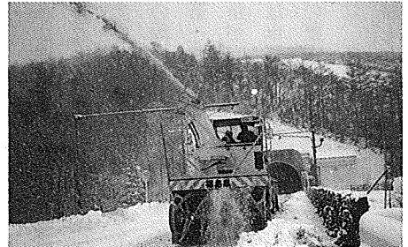
ロータリー車による除雪状況
