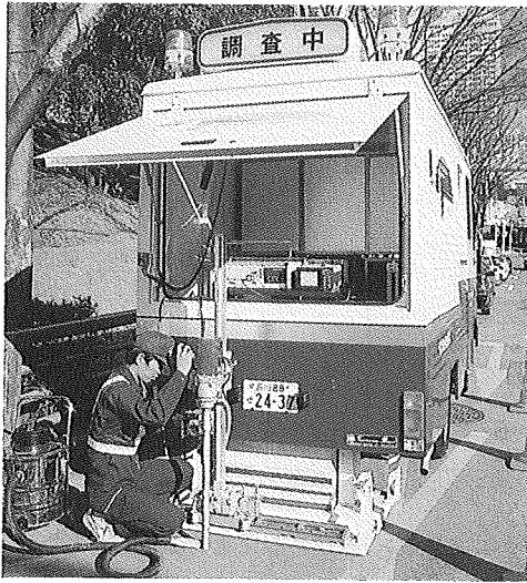
写真2 路面下空洞探査
