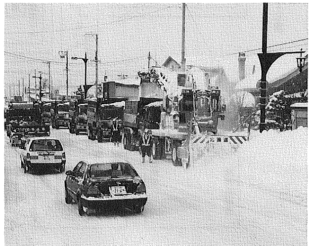
写真5 一車線積込みロータリー除雪車による排雪状況
