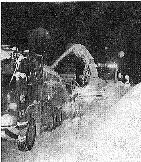
写真3 青森市内運搬除雪状況
