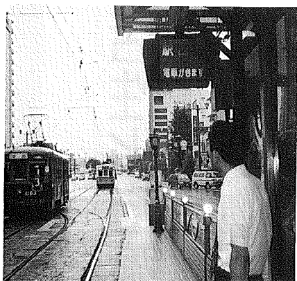
写真1 広島電鉄(株)の電車接近表示器(上)と路面電車運行状況表示装置(電車ロケーション)(右)
