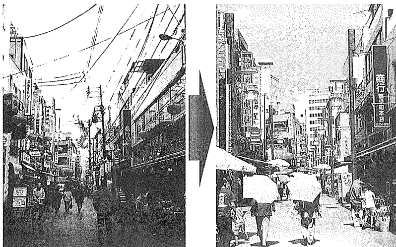
写真1 電線地中化による都市景観の向上
