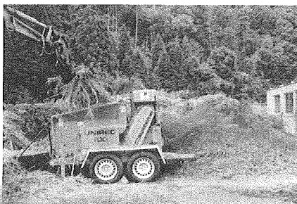
写真3 剪定枝葉の破碎状況
