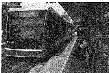
図6 乗降場と路面電車の車両の乗降口の床面とはできる限り平らとすることを規定
