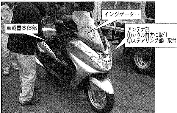
写真8 二輪車用ETC車載器搭載状況(スクータータイプ)
