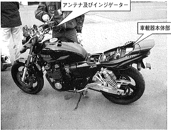
写真7 二輪車用ETC車載器搭載状況(ネイキッドタイプ)
