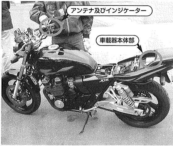
写真3 二輪車用ETC車載器搭載状況 (試行運用)
