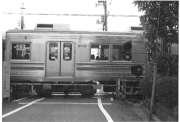
写真11 駅に停車中はずっと閉まりっぱなしの踏切 (踏切に停車する車両からは乗降不可能)
