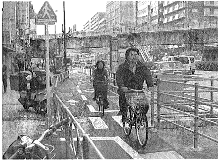
写真20 防護柵で車道、歩道と完全に分離された幅2mの自転車、安心安全に走行できます
