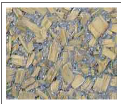
①間伐材チップ+ コンクリート混合
