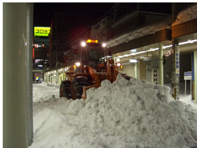
写真3 タイヤショベルにて雪を集積
