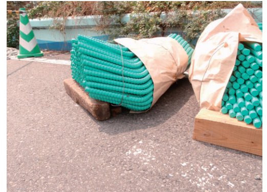
●図10 - エポキシ樹脂被覆鉄筋写真
