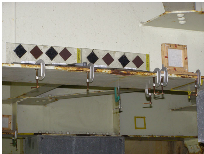
b) 耐候性鋼板ワッペン設置状況
