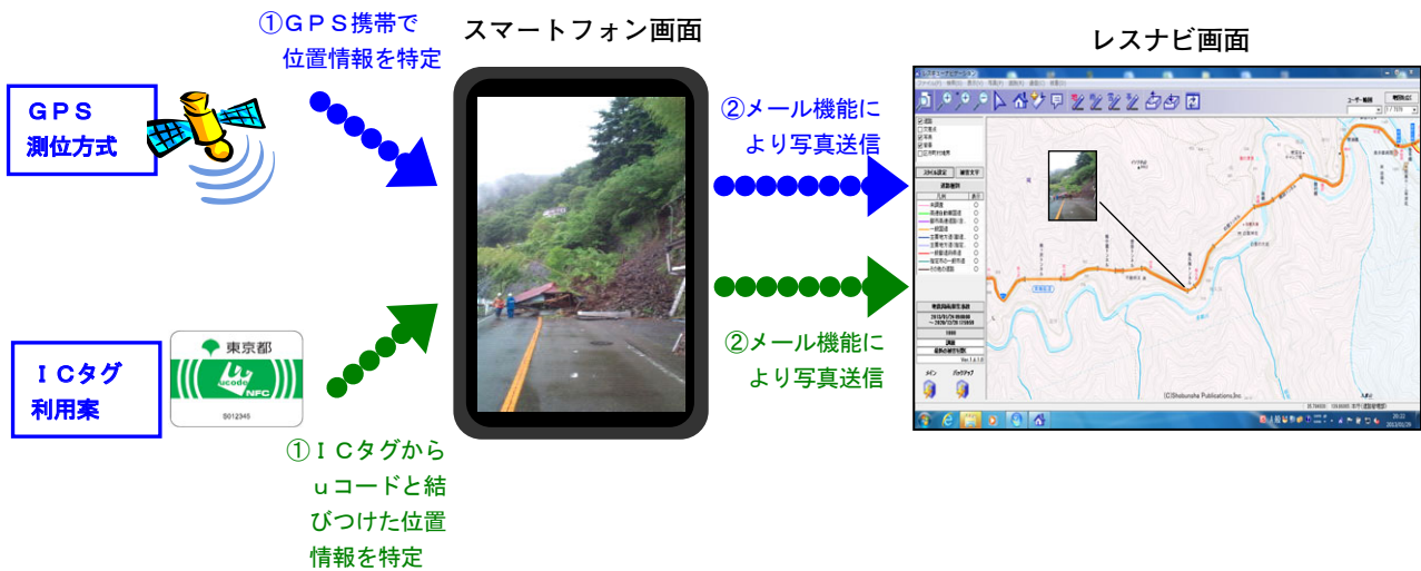
図-19 GPS測位とICタグ利用による位置特定
