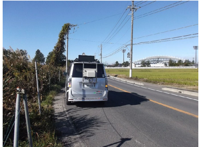
路面画像撮影車による路面調査
