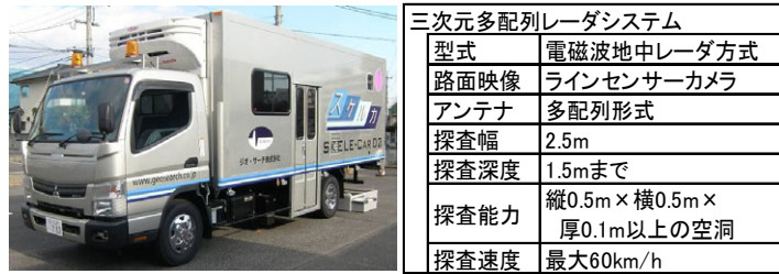
図-1 空洞探査車仕様諸元
