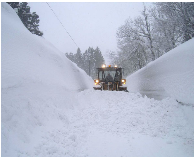
タイヤドーザによる除雪
