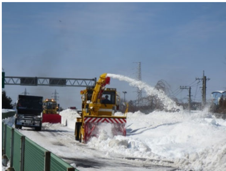
《ロータリー除雪車による排雪作業状況》
