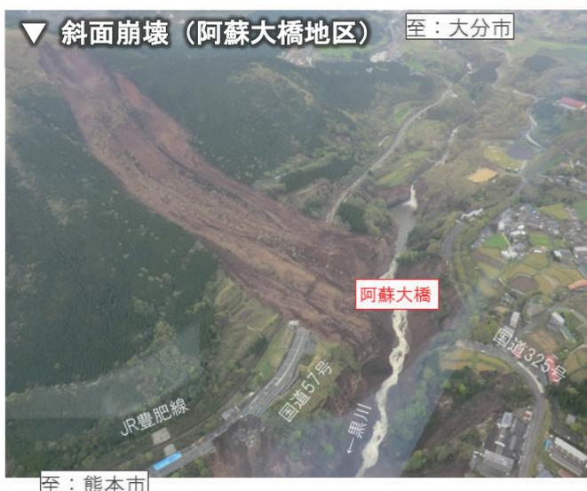
写真-3 国道 57 号阿蘇大橋地区斜面崩壊状況
