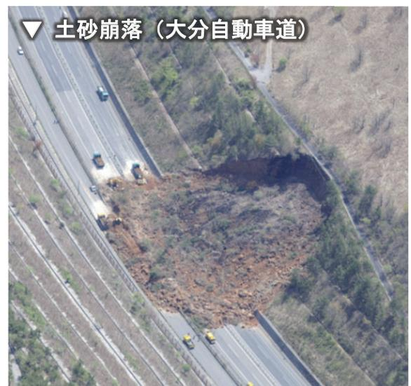
写真-4 大分自動車道切土法面崩壊状況
