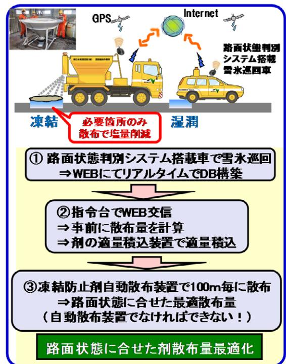
凍結防止剤最適自動散布システム (ISCOS)
