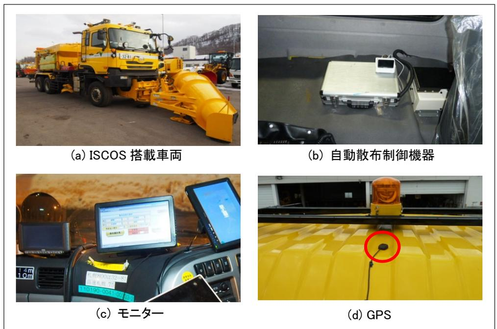
凍結防止剤散布車への ISCOS 搭載状況
