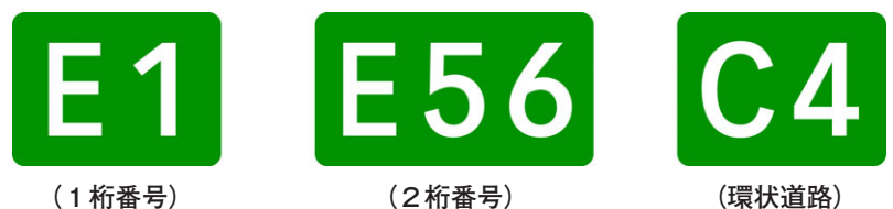
図-1 「高速道路番号」標識の新設
