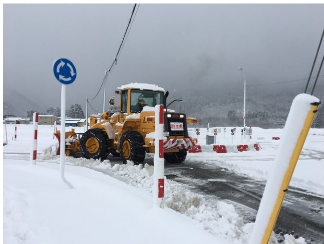
写真③ 除雪ドーザ作業風景
