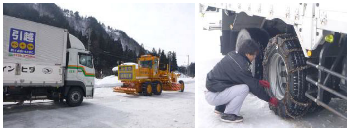
図-16 スタック車両の牽引訓練の様子(写真:左) 車両へのチェーン装着の様子(写真:右)
