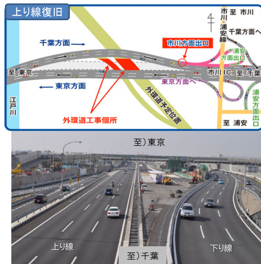
図-15 京葉道路の迂回状況
