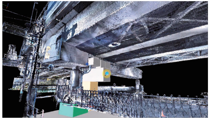
図-8 設計シミュレーション（補強時の部材配置検討）
