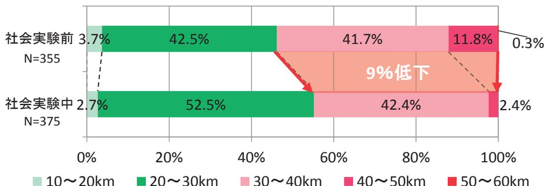
図6 朝ピーク時（7:30-8:30）における南北軸北向きの自動車の区間平均速度の変化
