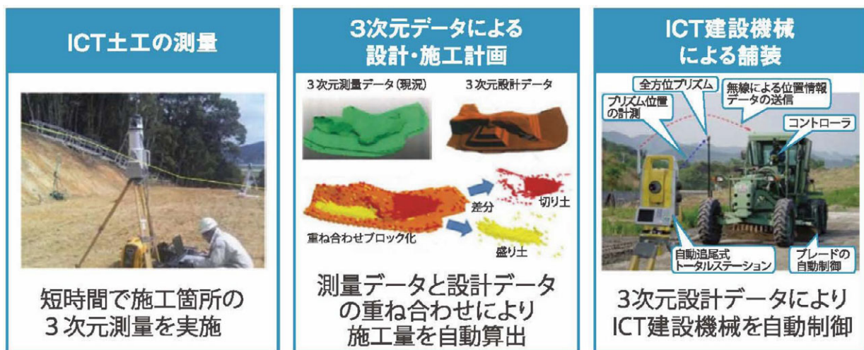
図-9 ICT活用工事の概要
