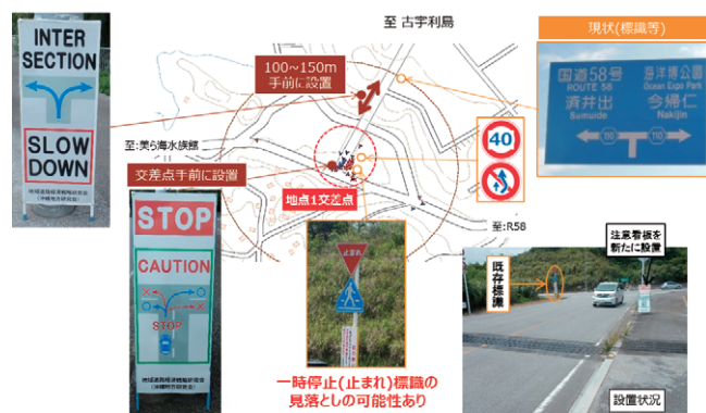
図-6 ピンポイント対策（看板設置箇所）
