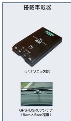
図 7-27 社会実験にて大型自動車に搭載する車載器
