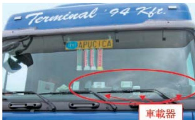
図 1-1-9 車載器設置例
