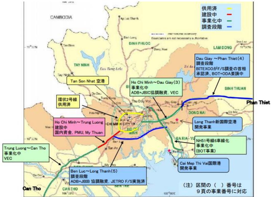
図 1-8-74 南部地域の高速度道路整備の状況
