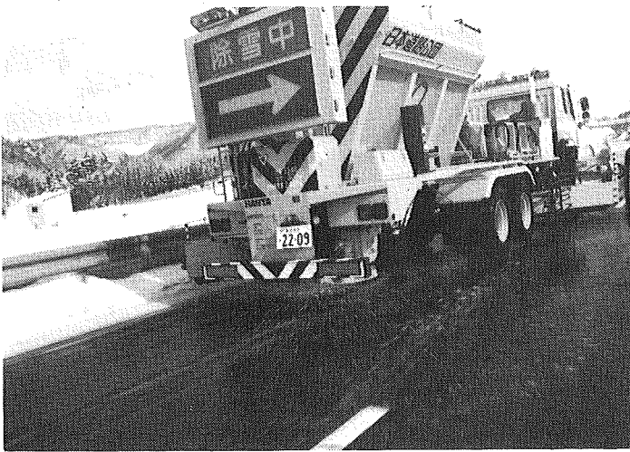
湿塩散布状況（凍結防止剤散布）
