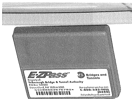
写真1 E-ZPassのタグ表面 (フロントガラスに貼った状態)
