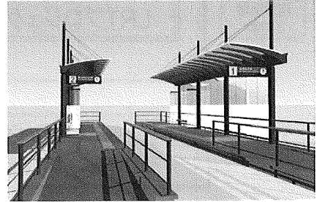
斜路（手摺部分）による段差解消
