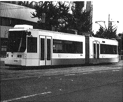
写真3 我が国最初の低床車両（熊本市）
