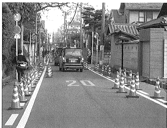
写真2 クランク実験の様子
