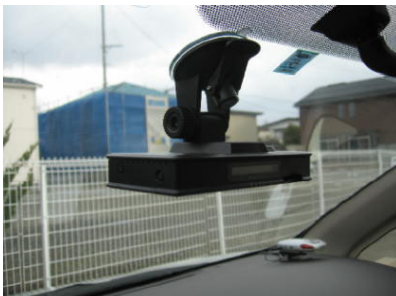
【写真-4】 ドライブレコーダー取付状況
