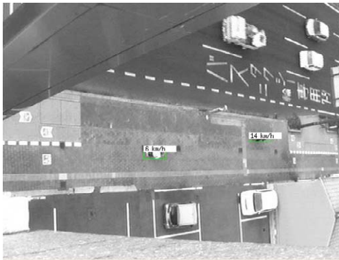
図-8 画像解析による速度計測のイメージ
