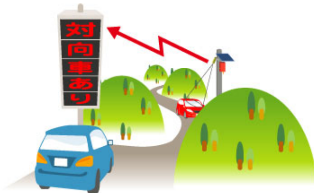
図3-1 中山間道路走行支援システムのイメージ図
