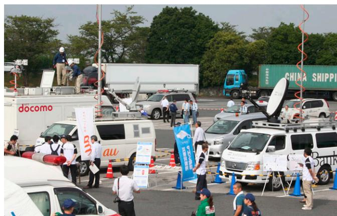
写真-6 携帯電話3会社による車載型移動基地局の立ち上げ訓練（NTTドコモ、au、Softbank）
