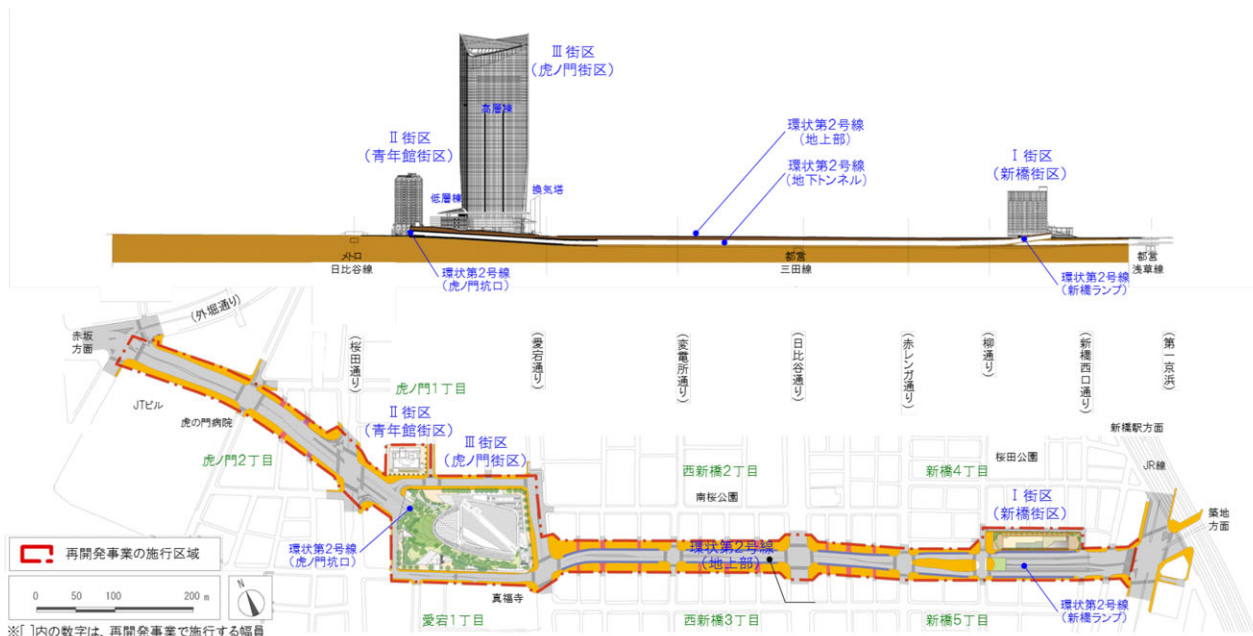
図-2 環状第二号線新橋・虎ノ門地区市街地再開発事業の平面図と断面図
