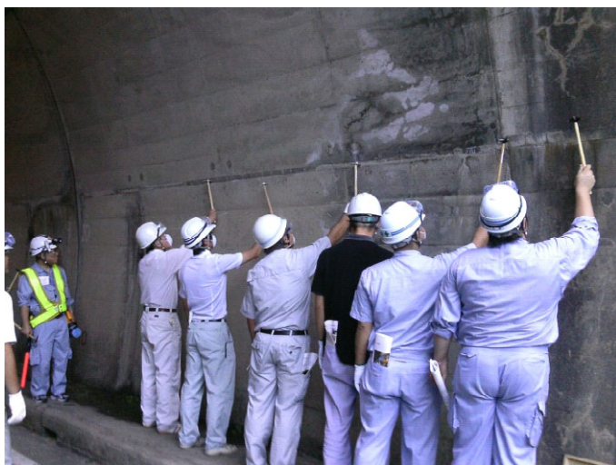
写真3 テストハンマーによる打音点検講習
