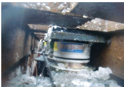
現地载荷試験による荷重計測
