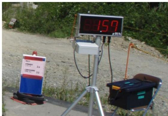
写真－8 移動式線量測定・表示器
