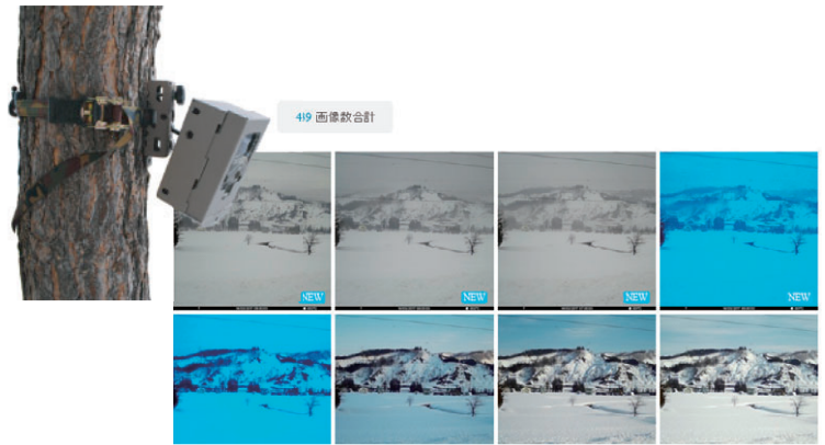
写真 11 トレイルカメラによる被災斜面の画像配信
