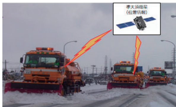
安全で高度な除雪作業を行うため準天頂衛星「みちびき」の正確な位置情報を利用
